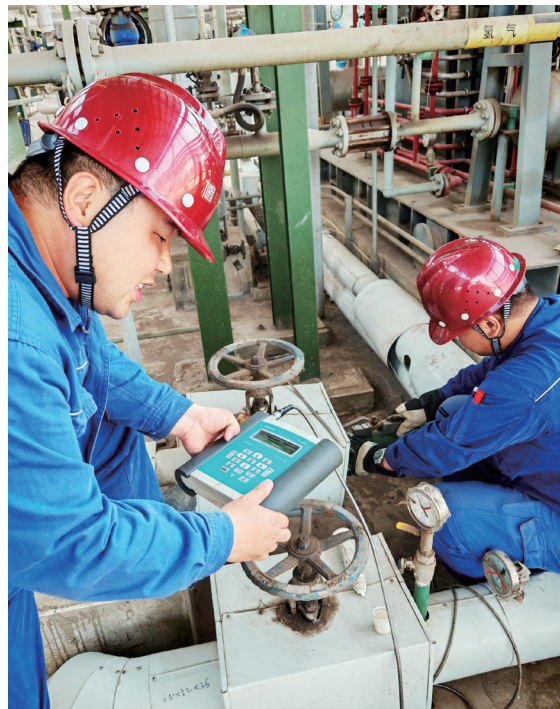
圖5-8 集團樂亭園區使用「FLUXUS F60X」在線流量檢測儀組織水系統查定
